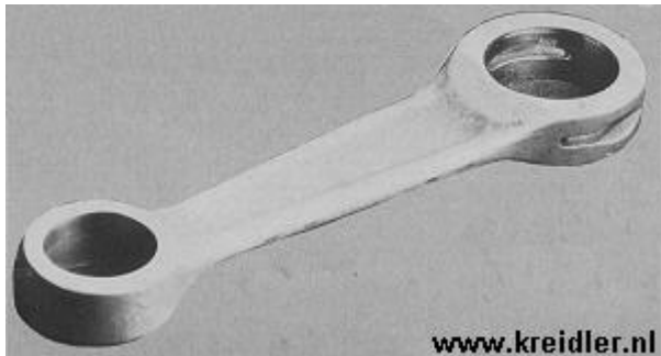
Beschadigingen in een big-end laten zich niet altijd zo duidelijk zien als hier. Onrondheid bijvoorbeeld treedt op in duizendsten van mm's.
