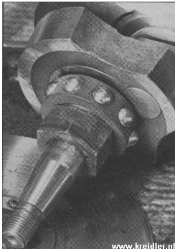
Wanneer het zes- of achtkant zo ingeslagen is verliezen we vermogen. Let ook op de beschadigde schijf. Beschadiging te zien langs rand zeskant.
