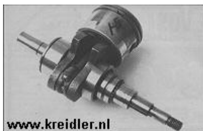
Hier een zuiger uit een grasmaaier. Zo goed als hier zullen glimpekken niet altijd te zien zijn.
